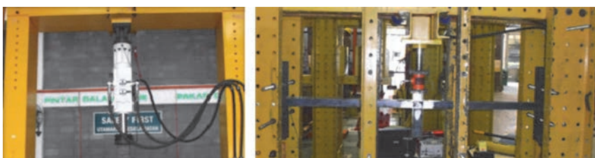
Slika 6. Dinamički pogon i hidraulični uređaj koji služi za procjenu pri seizmičkom i progresivnom kolapsu
