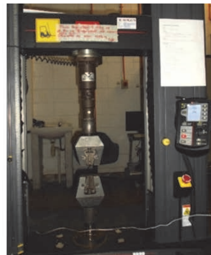
Slika 7. Krivulje stvarnih naprezanja i deformacija te naprezanja i deformacija dobivenih ispitivanjima (lijevo), univerzalni uređaj za ispitivanje (desno)
