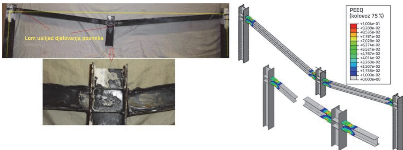
Slika 10. Oštećenje priključka nakon završetka ispitivanja progresivnog kolapsa i raspodjele ekvivalentnih plastičnih deformacija
