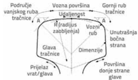
Slika 4. Zona lokacije oštećenja squat na glavi tračnice: površina kotrljanja
