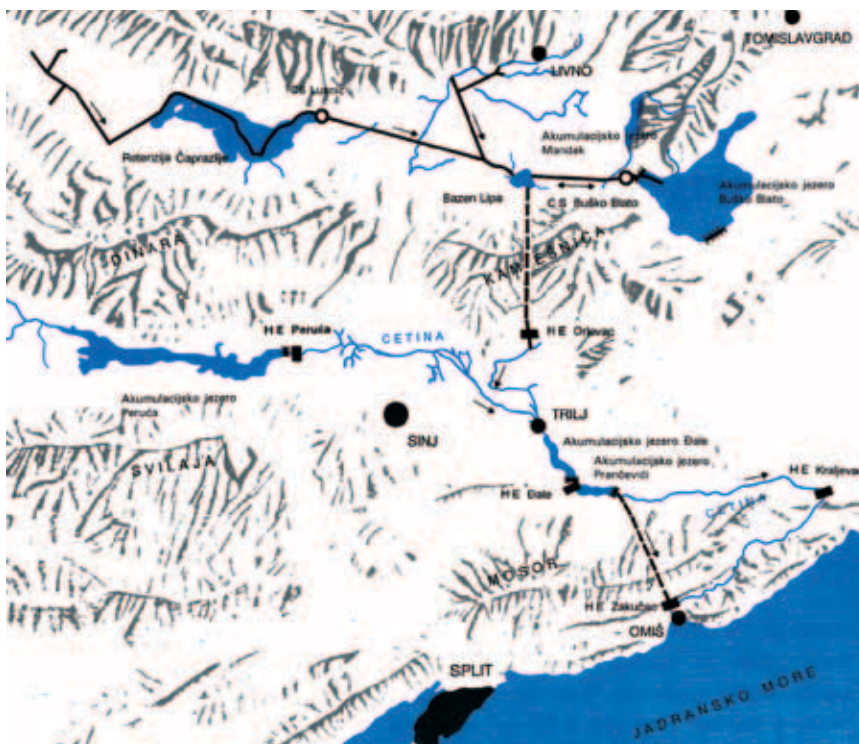
Prikaz hidroenergetskog sustava Cetine
