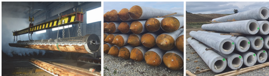
Slika 2. Prefabricirani AB piloti (izvedba, vrh pilota – čelični šiljak, glava pilota)
