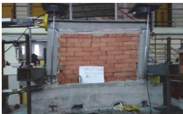
Slika 18. Okvir s ispunskim suhozidom i sljubnicom morta s velikim pomakom od 80 mm (omjer pomaka 0,1)
