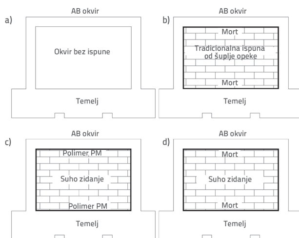
Slika 1. Shematski prikazi okvira: a) Okvir bez ispune; b) Okvir s tradicionalnom ispunom; c) Okvir sa suhozidom i polimernim vezivom; d) Okvir sa suhozidom i mortom
