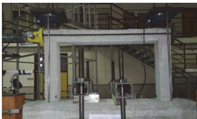
Slika 7. Cikličko ispitivanje okvira bez ispune
