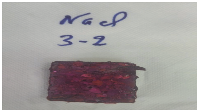
Slika 10. Test karbonizacije nakon 1 dana ekstrakcije iz NaCl
