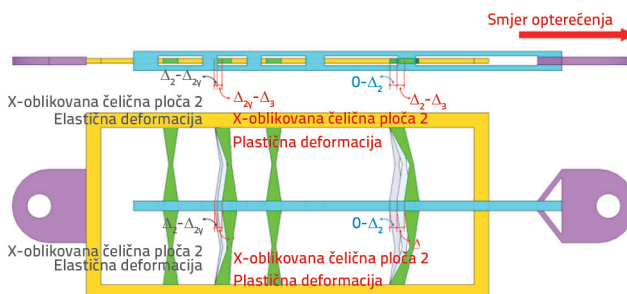
Slika 5. Uključivanje prigušivača drugog reda u radnoj fazi
