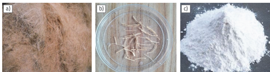
Slika 1. Prirodna vlakna i nanosilika: a) Sirova kokosova vlakna; b) Celulozna kokosova vlakna; c) Nanosilika
