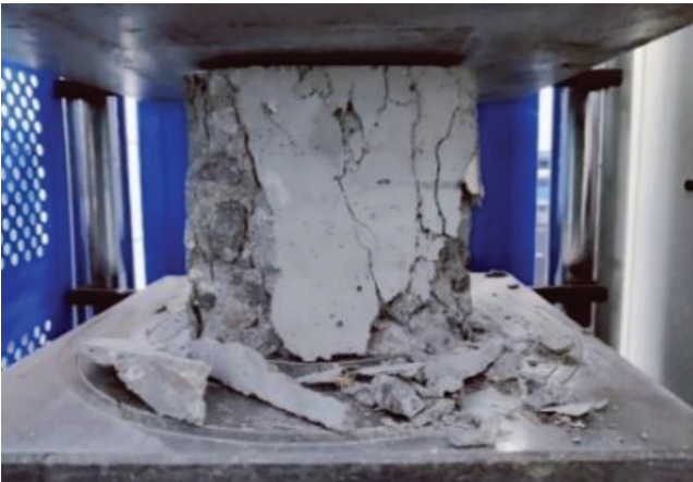
Slika 2. Uzorak loma standardnog betonskog ispitnog bloka
