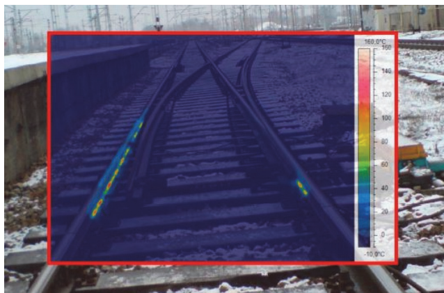
Slika 23. ICT snimka skretnice s prikazom temperatura grijača [101]
