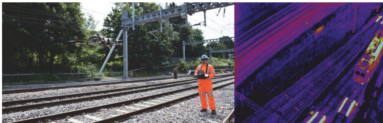
Slika 25. Upotreba bespilotnih letjelica i termografije za kontrolu ispravnosti grijača na skretnicama [114]
