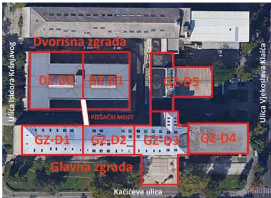
Dilatacije glavne zgrade Arhitektonsko-građevinsko-geodetskoga fakulteta
