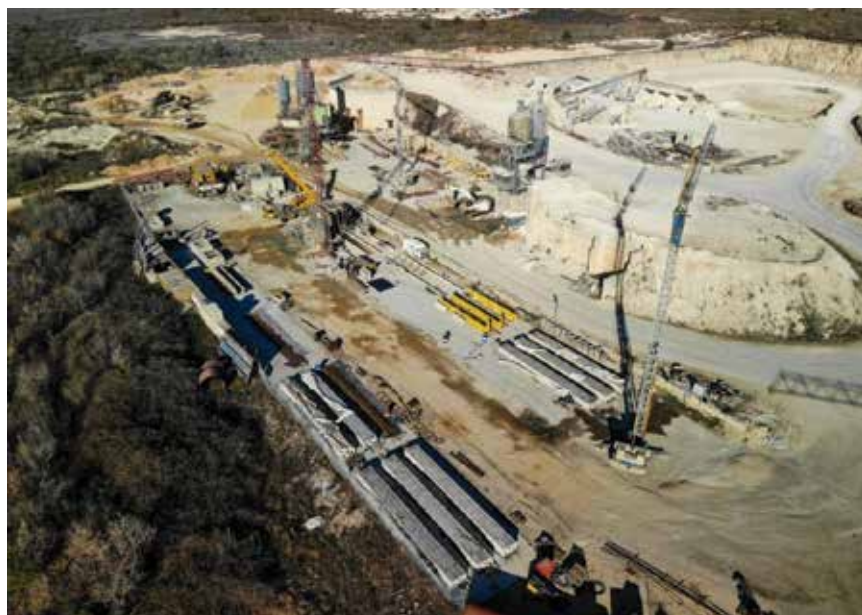
U pogonu za proizvodnju predgotovljenih elemenata proizvedeni su svi elementi za izgradnju propusta
