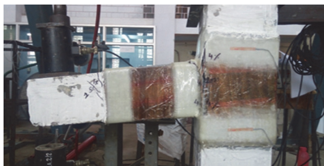
Slika 17. Raspored pukotina na uzorku S2ARF pri pomaku od 5 %
