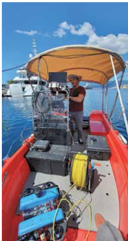
LBL sustav instaliran na ispitnoj brodići (izvor: ICUCM)
