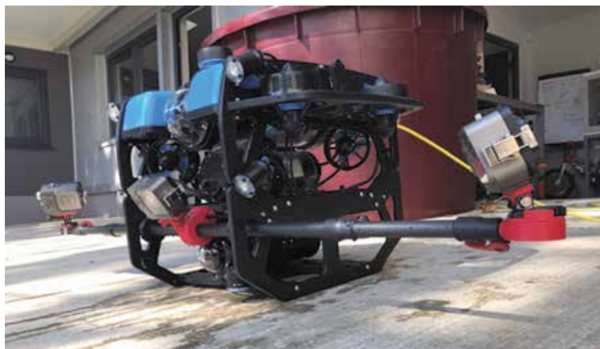
Fotogrametrijski ROV opremljen s četiri visokorazlučive kamere i 360° sonarom (izvor: Vectrino d.o.o.)
