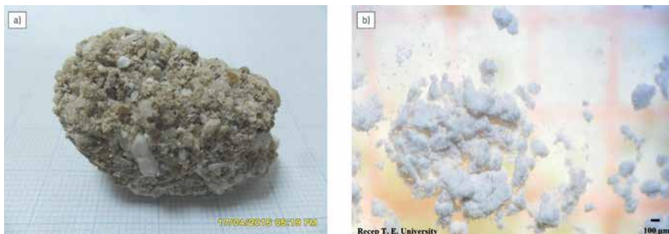
Slika 2. Stereooptička mikroskopska slika: a) nesamljevenog (U-3 m) minerala uleksita; b) samljevenog (U-25 μ) × 45 uvećanja
