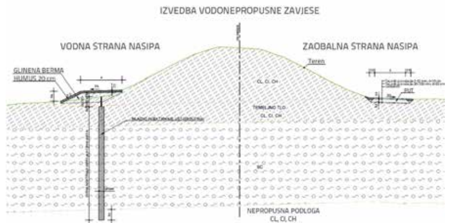
Karakteristični presjek rješenja s vodonepropusnom zavjesom uz tijelo nasipa
