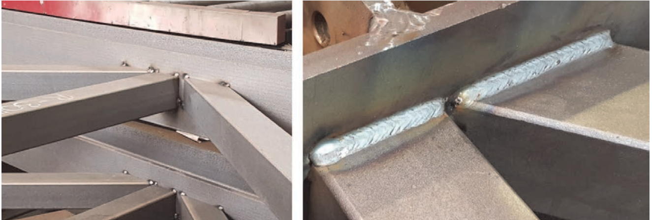
Predmontaža točkastima zavarima (lijevo), zavar prije obrade (desno)
