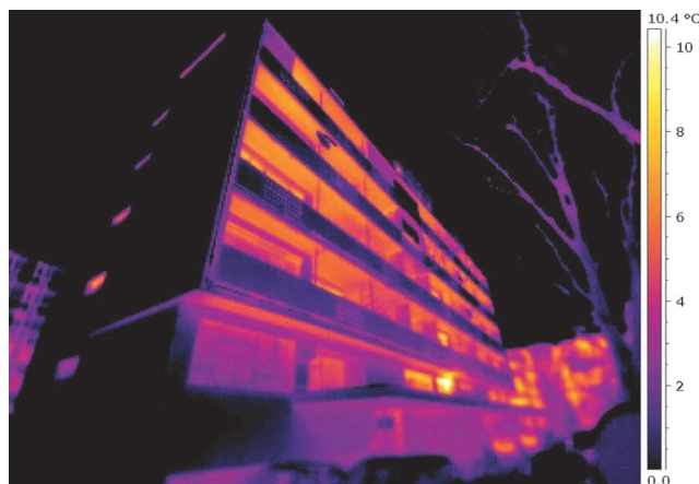
Termografska snimka južnoga pročelja nakon energetske obnove [2]
