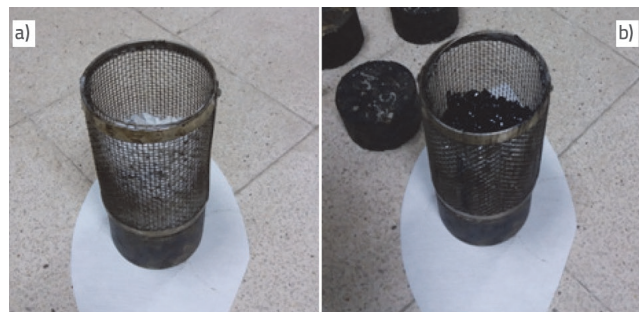
Slika 5. Postavljeno ispitivanja sa žičanom košarom
