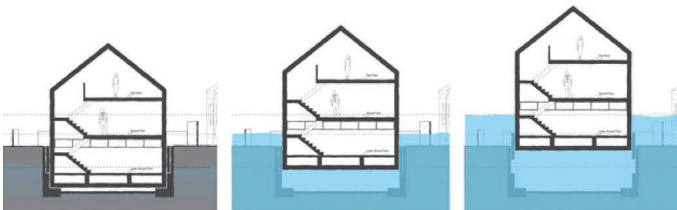
Prikaz principa plutanja
