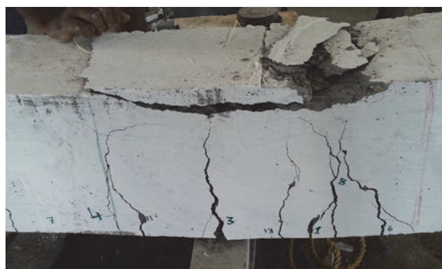
Slika 15. Oblik pukotina i vrsta loma kontrolne grede (CS11)
