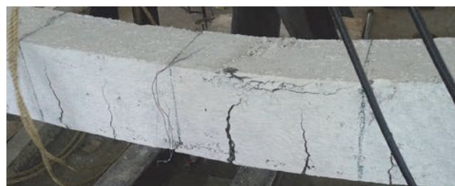
Slika 17. Oblik pukotina i vrsta loma armiranobetonske grede s dodatkom 40 % bakrene zguře i 0,4 % PP vlakana
