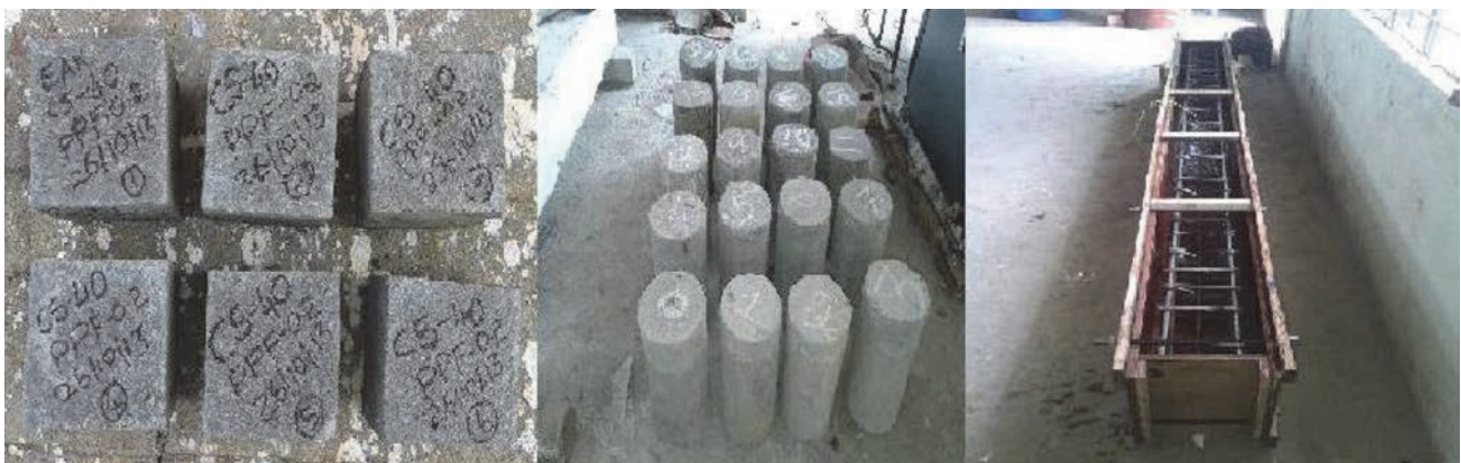
Slika 4. Pripremljene betonske kocke, valjci i kalup za betonsku gredu s postavljenom armaturom
