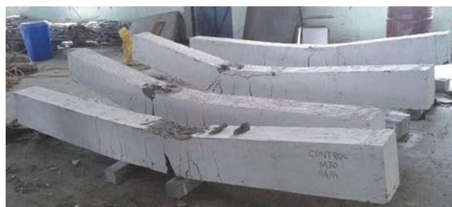
Slika 14. Armiranobetonske grede nakon ispitivanja
