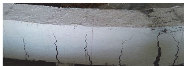
Slika 18. Oblik pukotina i vrsta loma armiranobetonske grede s dodatkom 60 % bakrene zguře i 0,4 % PP vlakana
