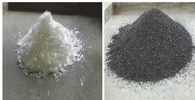
Slika 1. Korišteni materijali: PP vlakna (lijevo), bakrena zgura (desno)
