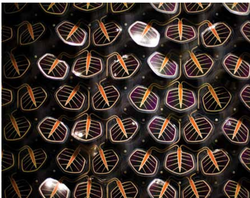
Svaki list-panel koji se hrani energijom sunca i vjetra sastoji se od brojnih sitnih uređaja u kojima se nalaze fleksibilne fotonaponske pločice kombinirane s piezo generatorima
