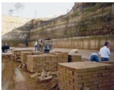
Slika 3. Izrada cigli od zeolitnog tufa
