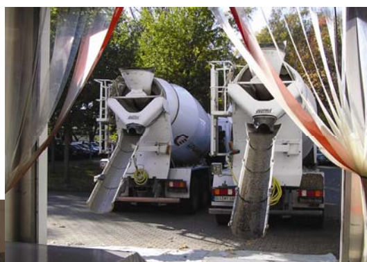
Rampa automiješalice nakon betoniranja
